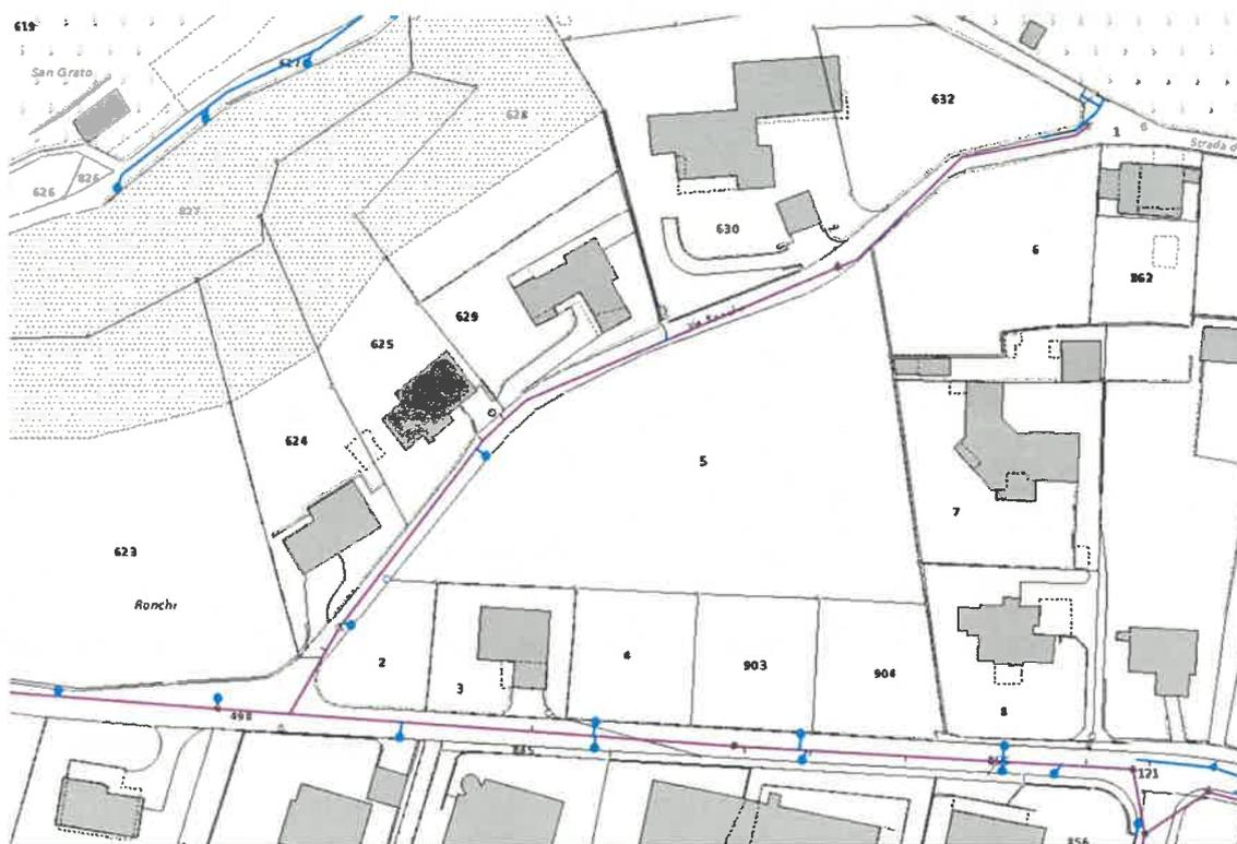
Figura 4 - Stralcio planimetrico con canalizzazioni esistenti in via Roculin (fonte: webGis di Lamone)
